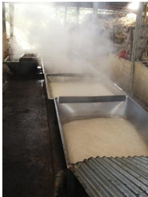
Imagen 14. Evaporación y concentración de jugos. (La Tobiana, Tobia, Quebrada Negra, Cundinamarca)
