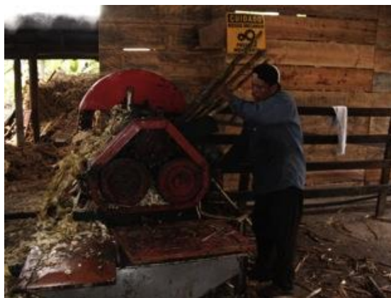
Imagen 8. Molino horizontal de tres mazas. (La Tobiána, Insp. Tobia, Quebrada Negra, Cundinamarca)
