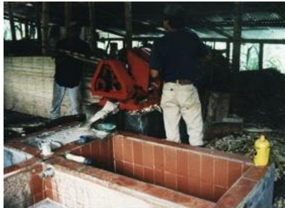
Imagen 9. Pre limpiador en concreto. (Tomado de la Guía Ambiental para el Subsector Panelero)
