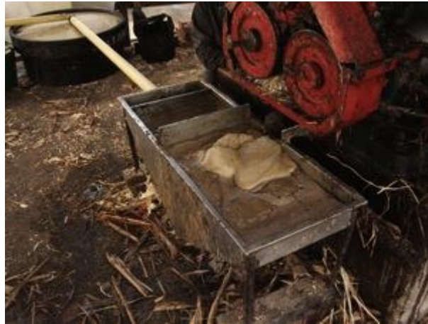
Imagen 10. Prelimpiador en acero. (La Tobiana, Insp. Tobia, Quebrada Negra, Cundinamarca)
