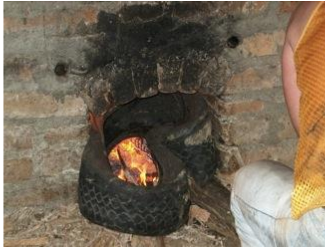
Imagen 18. Uso de llanta en una hornilla panelera de Caparrapí (archivo personal)
